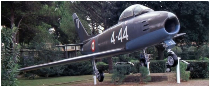
A sinistra Si è fatta chiarezza anche sull'identità del MM.19694 4-44 gate al 4° Stormo a Grosseto. La discontinuità del disegno della mimetica sul velivolo ha sempre alimentato il dubbio che si trattasse di un ibrido. Effettivamente, la parte anteriore della fusoliera appartiene alla M.M.19694 nc.594 ex XB856, che fu radiato in seguito ad un atterraggio senza carrello avvenuto a Brindisi il 29 maggio 1958. La parte posteriore di fusoliera proviene invece dal velivolo MM.19841 nc.741, incidentato a Pratica di Mare il 29 maggio 1958. La cellula così ottenuta fu trasferita sull'aeroporto di Capua, assegnata alla Scuola Specialisti di Caserta. Recuperato, divenne poi gate della base di Grosseto, unico Sabre mimetico esistente in Italia. Purtroppo, il motore del velivolo dopo il restauro venne ceduto con altri rottami al demolitore Bentivoglio che ancora oggi lo ha in deposito. (Foto Aeroflash)
