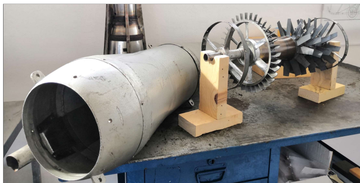
A sinistra Rapporto dimensionale tra carenatura esterna del "generatore di spinta" e complesso rotori.
