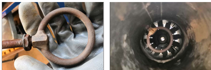
A sinistra Particolare dell'anello con ipotetiche funzioni di "flameholder" e una vista del suo posizionamento.
